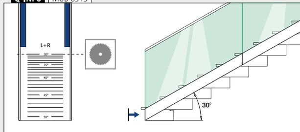
Bodenprofile zur Bodenmontage
