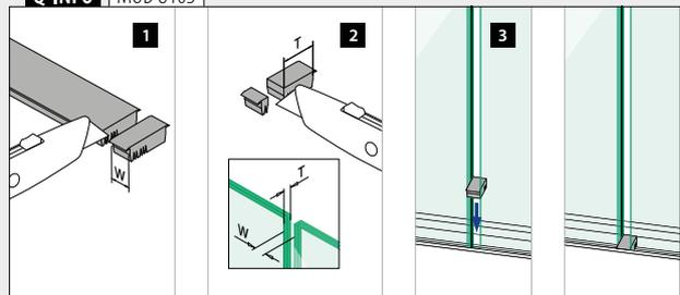
**Bodenprofile zur Bodenmontage**
