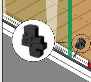
Bauanschlussleisten zur Seitenmontage
