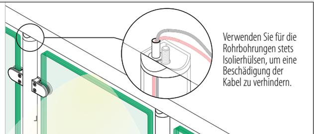
Verwenden Sie für die Rohrbohrungen stets Isolierhülsen, um eine Beschädigung der Kabel zu verhindern.
