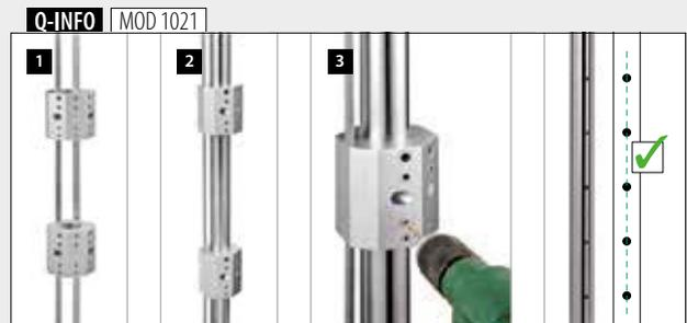
Bohren und Gewindeschneiden
