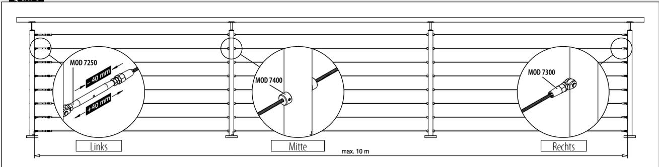
Drahtseilstopper zur diagonalen Montage
