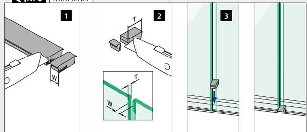
Bodenprofile zur Bodenmontage
